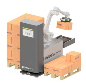
Tevens is de HiP-020 ook uitgerust met de palletizing software van WePall. Dit maakt het gemakkelijk om de machine eenvoudig en snel te implementeneren in uw bestaande productie omgeving. Mocht u geïntreseerd zijn om de gehele productie te automatiseren is deze applicatie ook geschikt om communiceren met de Neura MAV (Automatic Guided Vehicle). Lees hierover meer op de volgende pagina.
